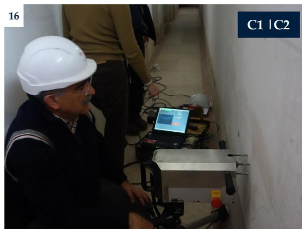
**Figuras 11 a 16-** Fotografias ilustrativas do ensaio de resistência à perfuração (DRMS) realizado nas diversas áreas A3 (fig.11), A4 (fig. 12) A7 (fig. 13), A8 (figs. 14 e 15) e C1|C2 (fig.16).
